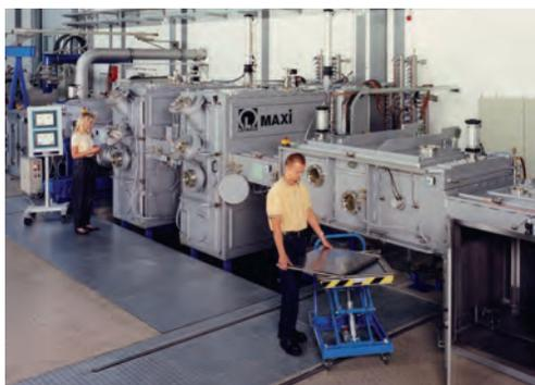
*In-line Beschichtungsanlage für Platten und metallische Bänder MAXI*
